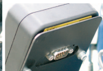
Porta seriale per scarico dati Serial port for downloading data Port série pour téléchargement des données Serial Port zur Datenentnahme
