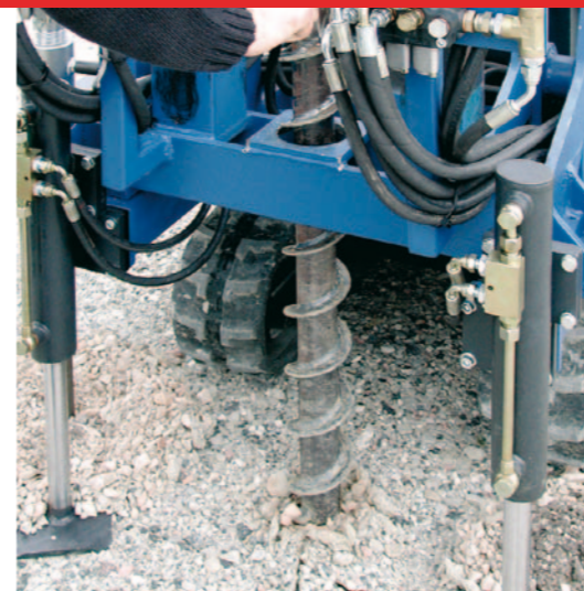
Campionamenti a trivellazione / Drilling sampling Echantillonnages par forage / Probenentnahme mit Drehbohrungen
