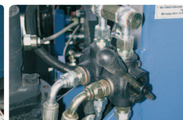
Leve comando velocità motori Motor speed control levers Leviers de commande vitesse moteurs Bedienungshebel Geschwindigkeit Motoren
